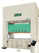
Двухкривошипные прессы серии SAG предназначены для штамповки габаритных деталей из листовой стали. Высокий уровень автоматизации прессов этой серии позволяет использовать их последовательно в линии, что значительно снижает цикл изготовления конечной детали.
