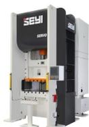
Однокривошипные механические прессы с сервоприводом являются совершенно новым решением для реализации задач по холодной штамповке деталей. Данный сервопресс подходит для изготовления простых и сложных деталей различной формы методом штамповки.
