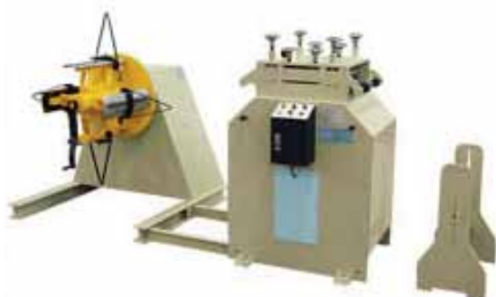
2 в 1 устройство размотки и правки
