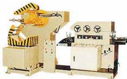
3 в 1 устройство размотки, правки и подачи
