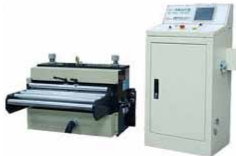
Сервоприводное устройство подачи, синхронизируемое через командо-аппарат с контроллером подачика
